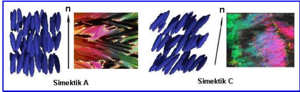
Şekil 2.15. Simektik sıvı kristallerde moleküllerin yönelimi ve polarize mikroskop kullanılarak çekilmiş fotoğrafları [Dierking, 2003].
