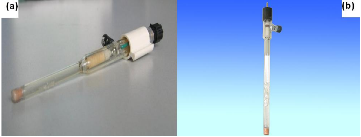
Şekil 3.5. (a) Doygun Kalomel referans elektrodu ve (b) Ag/AgCl referans elektrodu
