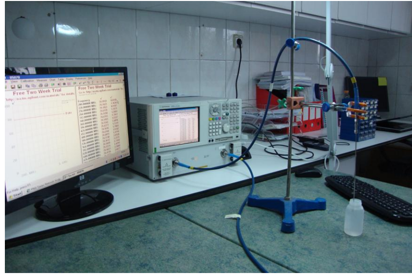
Şekil 3.7 Deiyonize Suyun Dielektrik Sabiti Ölçüm Sistemi
