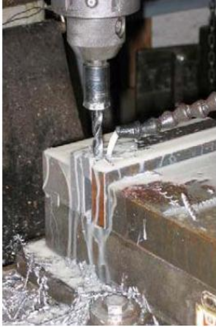
Şekil 2.1. Metal Kesme Sıvılarının Metal Kesme Esnasında Kullanımı
