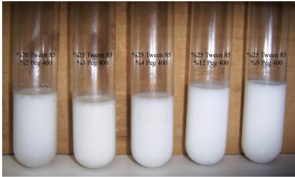
Şekil 4.2. Rafine ayçiçeği yağı ve Tween 85 karışımına farklı içerik yüzdesine sahip Peg 400'ün eklenmesiyle elde edilen metal kesme sıvıları
