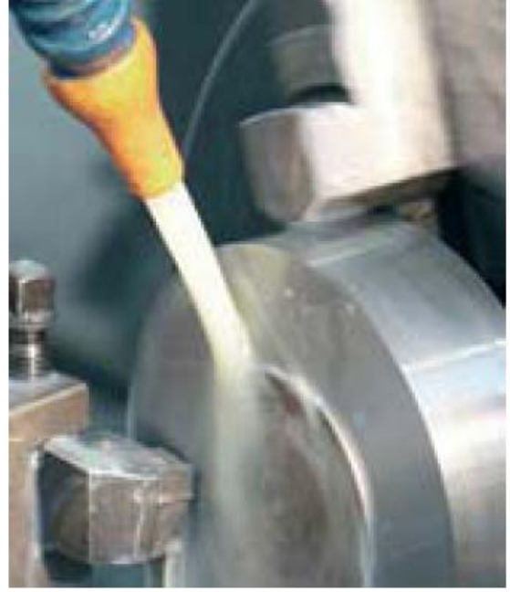
Şekil 2.1. Metal Kesme Sıvılarının Metal Kesme Esnasında Kullanımı
