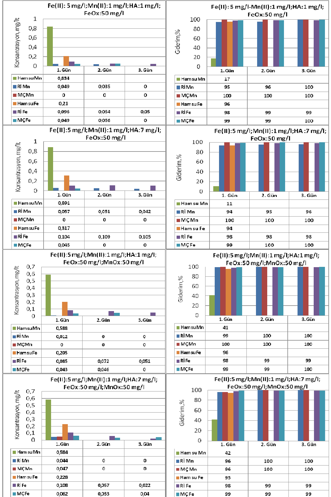
Şekil 4.37. Fe(II)-Mn(II)-HA-FeOx-MnOx kombinasyonlarını içeren çözeltilerde UF membranda ham su, reaktör içi ve membran çıkışta elde edilen demir ve mangan konsantrasyonları ve giderim yüzdeleri
