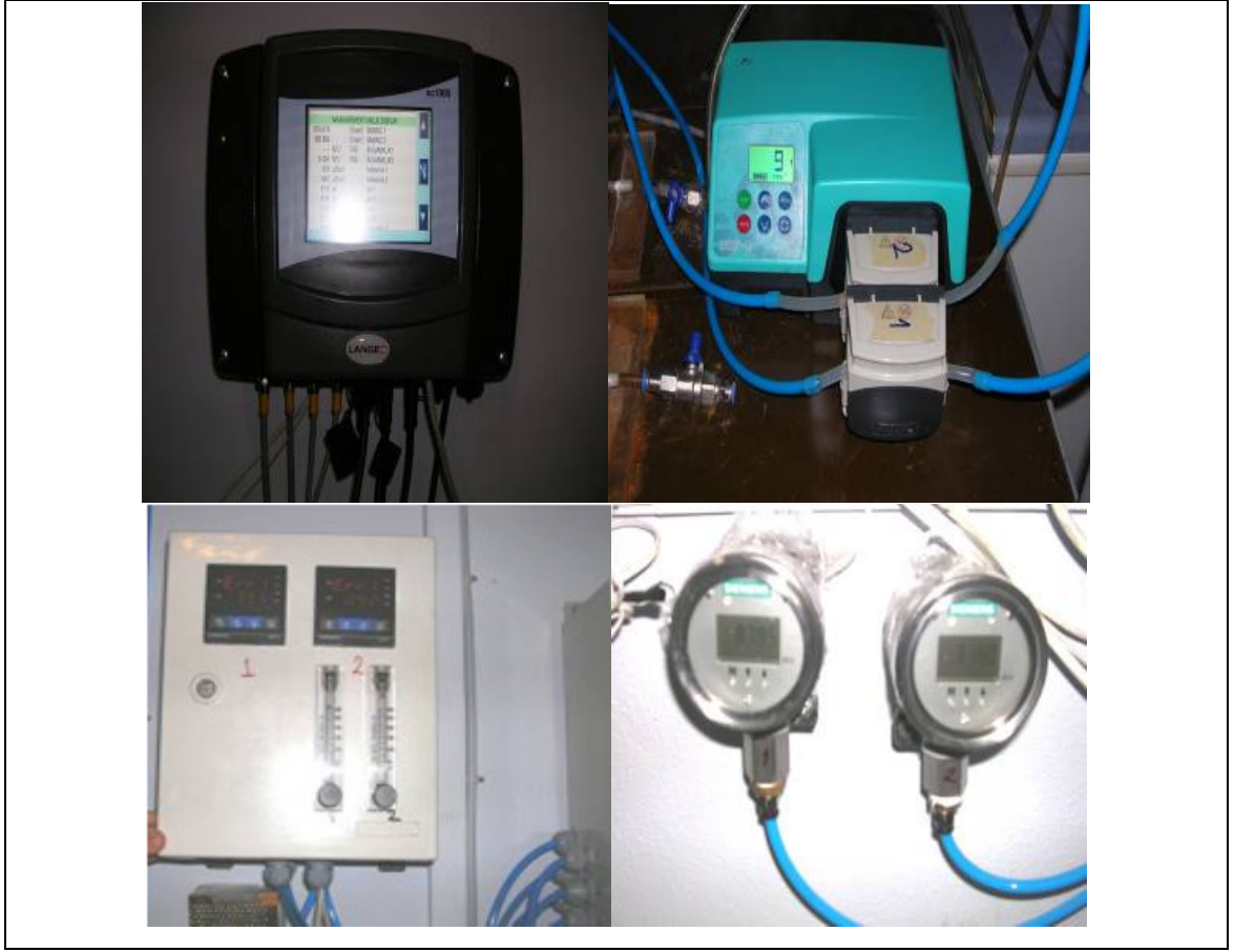
Şekil 3.5. Batık membran sistemi elemanları a) SC1000 data logger, b) Hamsu besleme ve vakum pompaları, c) Rotametreler, d) Basınçölçerler
