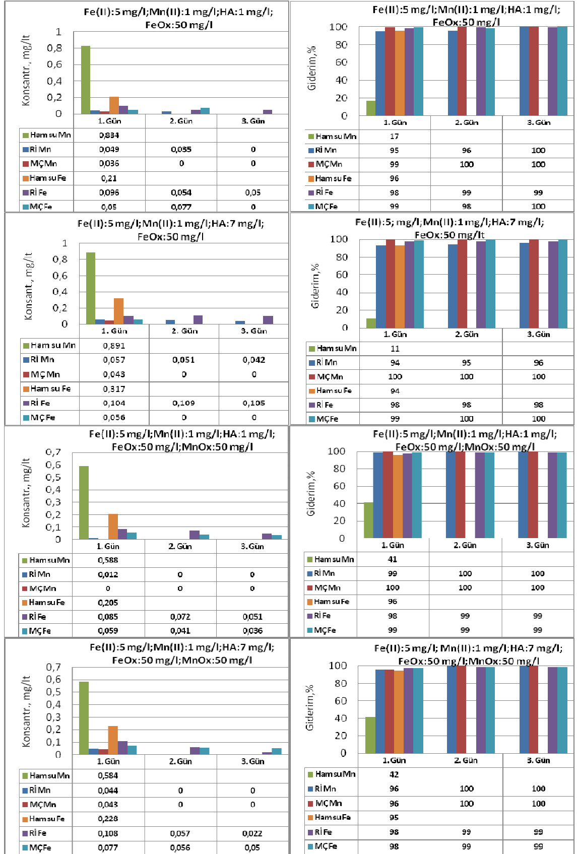
Şekil 4.25. Fe(II)-Mn(II)-HA-demir (oksi)hidroksit ve/veya mangan (oksi)hidroksit kombinasyonlarını içeren çözeltilerde elde edilen toplam demir ve mangan konsantrasyonları ve giderim yüzdeleri
