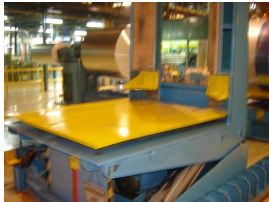
Şekil 4.3: Coil'in dreeler'a takılışı için kullanılan downender
