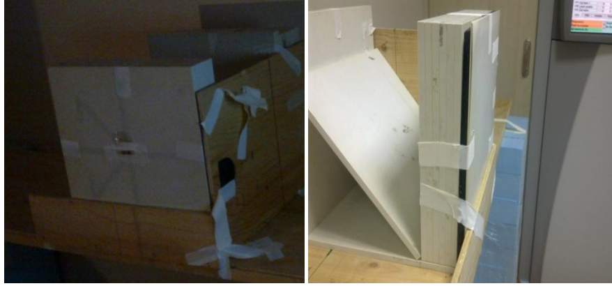
Resim 3.19. Kalibrasyon noktasında maksimum derinlikte TLD ışınlama kurulumu.
