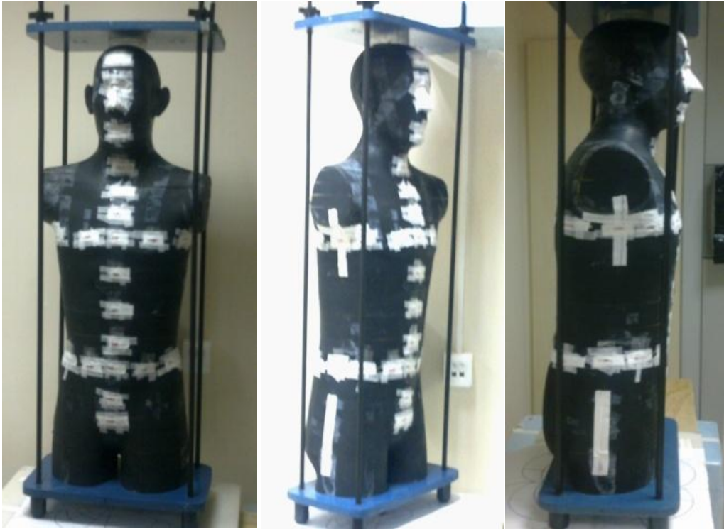
Resim 3.20. 12 ve 18 alan faktörlerinin hesaplanması için kullanılan antropomorfik fantom üzerine yapıştırılmış TLD'ler.
