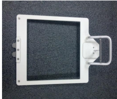
Resim 3.9. Gantry penceresine takılan ve HDRE modunun aktive edilebilmesini sağlayan HDRE aplikatörü.
