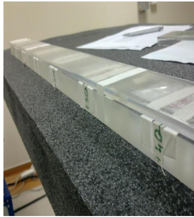
Resim 3.15. Profil ölçümü için 200 cm'lik pleksiglas üzerine sabitlenmiş TLD paketleri ve TLD paketleri üzerine sabitlenmiş pleksiglas.
