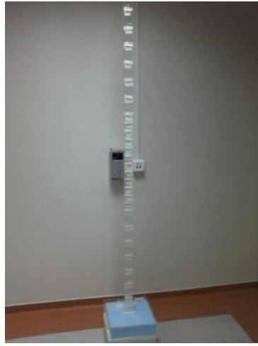
Resim 3.16. 310 cm KCM'nde gantriye dik olarak sabitlenmiş profil çubuğu.
