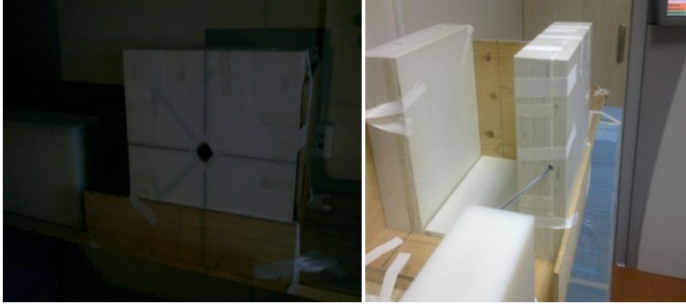
Resim 3.18. Gantri 90 derecede iken ışın merkezindeki paralel plan iyon odası ve 20 mm derinliğindeki paralel plan iyon odası için ışınlama kurulumu.
