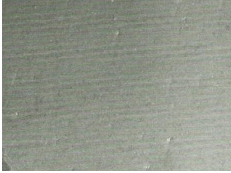
Şekil 4.1. CrN/AlN çok tabakalı filmlere ait örnek (R2) SEM mikroyapı görüntüsü
