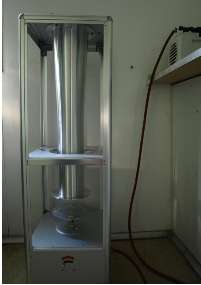
Şekil 3.26 Uygulamaların yapıldığı ilaçlama kulesi
