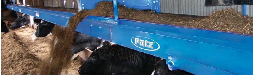
Şekil 2.27: Düz sıyırıcı ile hayvan yemlerinin boşaltılması.
