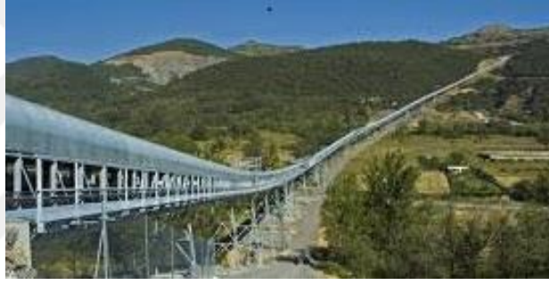
Şekil 1.2: Hat boyunca üstü korumalı bantlı konveyör.
