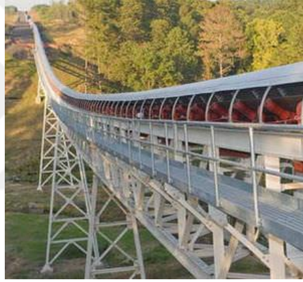
Şekil 1.1: Uzun mesafeler boyunca malzeme iletebilen bantlı konveyör.
