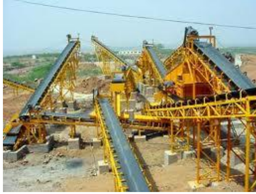
Şekil 1.4: Birbirlerine malzeme aktarımı gerçekleştiren bantlı konveyörler.
