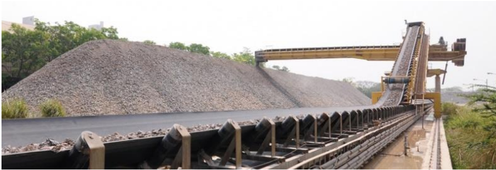
Şekil 1.6: Maden ocaklarında kullanılan bir bantlı konveyör.
