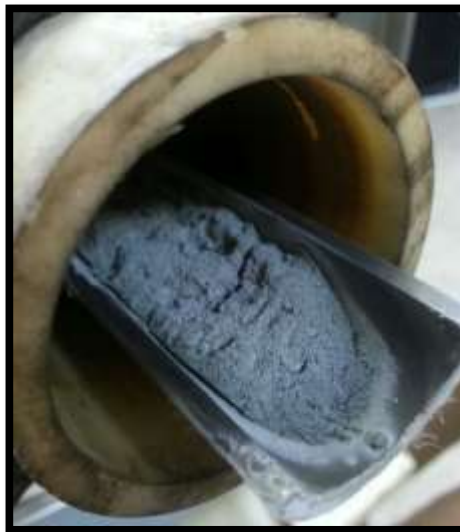
Şekil 6.4. Kayıkçığın tüp fırından çıkarılması
