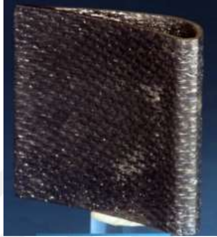
Şekil 4.8. Nasa tarafından üretilen türbin kanadı [79]
