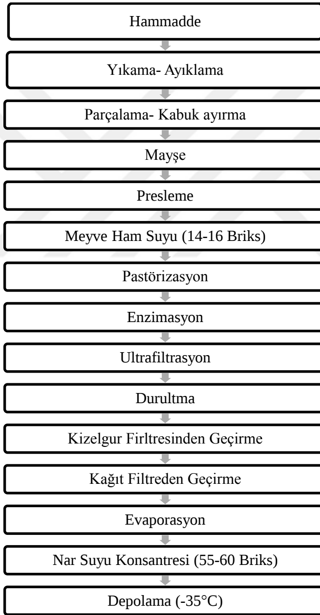
Şekil 2.4: Nar suyu konsantresi üretim akış şeması (Karaca,2011).
