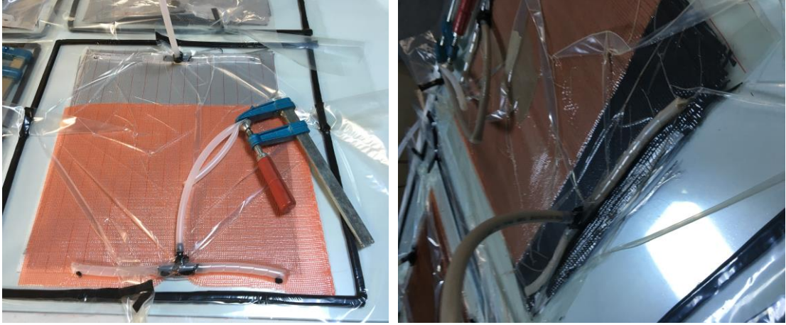
Şekil 6. 9 Sodyum Borat Katkılı Reçinenin Sisteme Verilmesi
