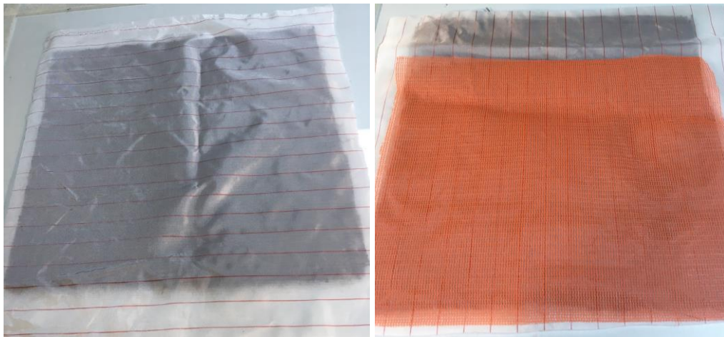
Şekil 6. 6 Soyma Kumaşı ve Akış Filesini Yerleştirilmesi
