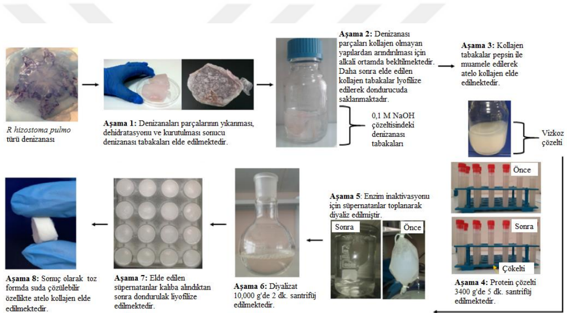
Şekil 3.2. Denizanasından kollajen izolasyonunun şematik gösterimi (Derkus ve ark., 2016)
