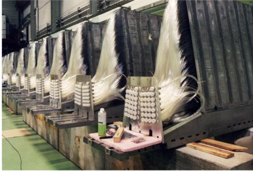
Şekil 4.4. Kuartz fiberlerin ve FÇT 'lerin yerleştirildiği HF kuleleri ( www.fnal.gov/pub/today/images/images04/Calorimeter_Wedges.jpg )
