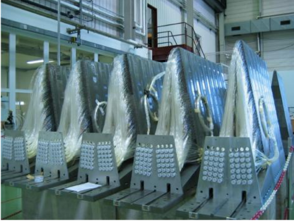
Şekil 3.10. Kuvars fiberlerin yerleştirildiği HF kuleleri ( https://cds.cern.ch/record/1431489/files/IMG_0195.jpg )
