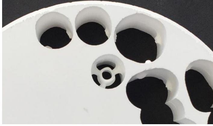
Şekil 3-9: Hibrit abutmentın kişiye özel olarak kazınan zirkonya parçası
