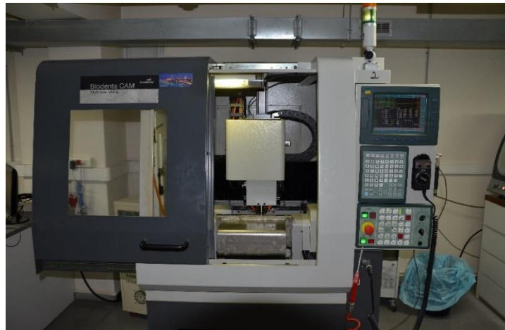
Şekil 3-11: CAD/CAM kişiye özel titanyum kazıma makinası
