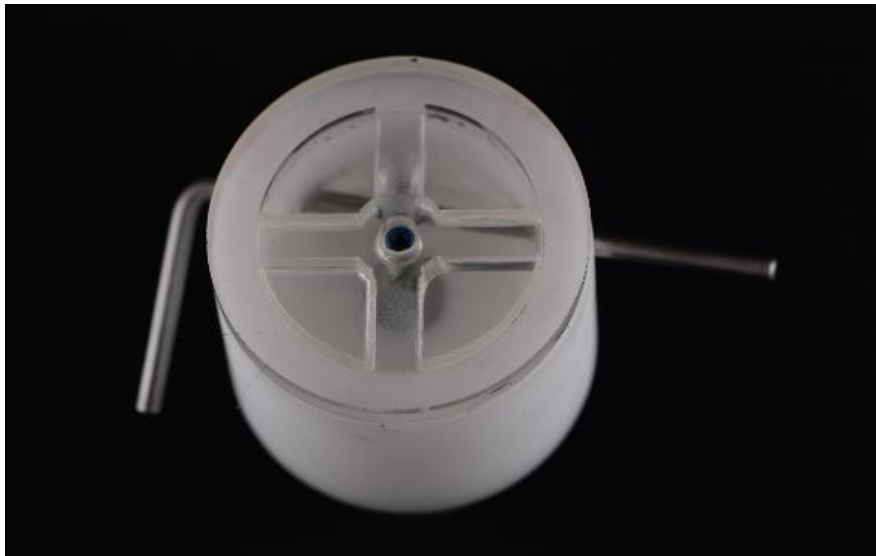
Şekil 3-21: İmplantın, özel bir parça kullanılarak haznenin ortasına yerleştirilmesi
