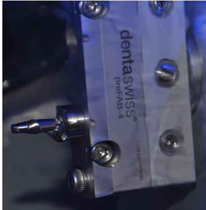
řekil 3-6: Kazıma sırasında preFAB-4 kiřiye özel titanyum abutment
