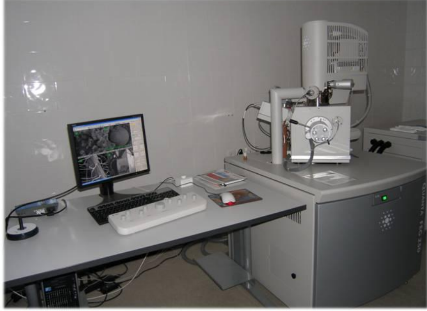
Şekil 3.13. Philips XL 30S FEG model taramalı elektron mikroskobu (SEM)
