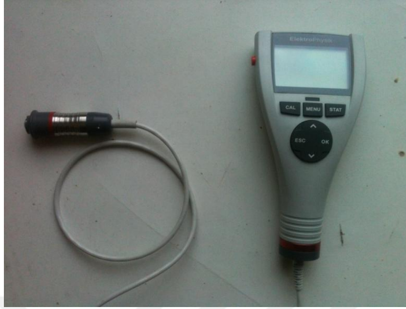
Şekil 3.16. ElektroPhysik Minitest 730/Sensor FN 1,5 HD model kaplama kalınlığı ölçüm cihazı
