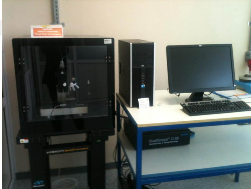
Şekil 3.18. IBIS Nanoindentation System DME-DS 95 Series AFM model indentasyon cihazı
