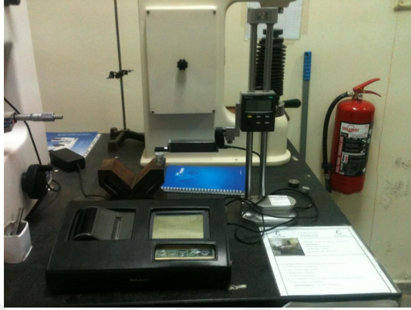
Şekil 3.15. Mitutoyo SurfTest SJ-301 marka yüzey pürüzlülük ölçüm cihazı
