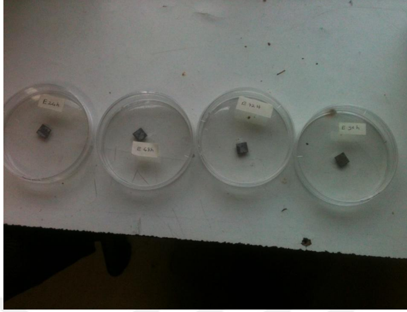
Şekil 3.17. Indentasyon ölçümleri için belirlenen 10x10x1,2 mm ebatlarındaki kare numuneler
