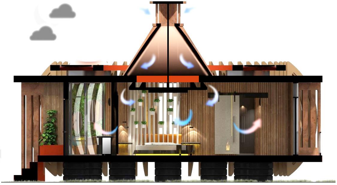
Resim 3.9. Rüzgâr Kulesinin Gece Saatlerinde Çalışma Prensibi Kesiti.
