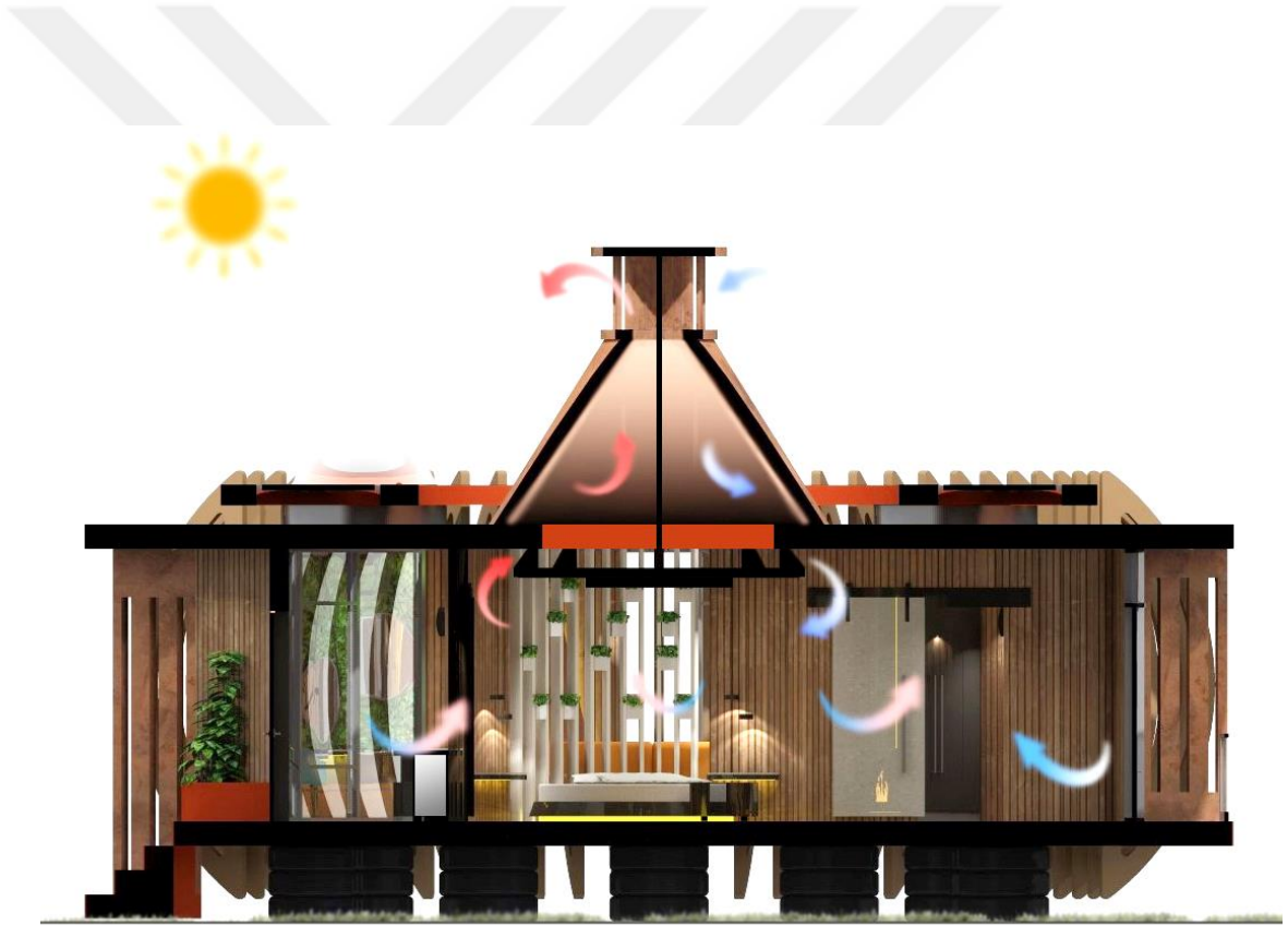
Resim 3.8. Rüzgar Kulesinin Gündüz Saatlerinde Çalışma Prensibi Kesiti.
