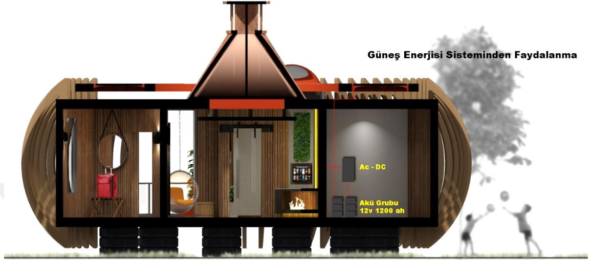
Resim 3.11. Güneş Enerjisi Üretim ve Depolama Prensipte Kesiti.
