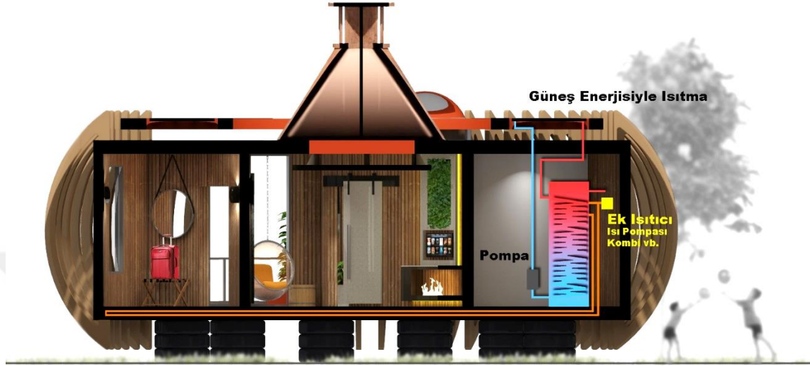
Resim 3.10. Güneş Enerjisi İle Zeminden Isıtma Prensip Kesiti.
