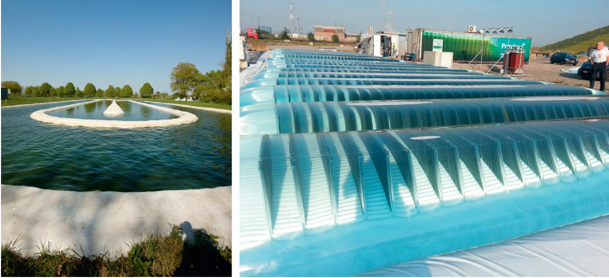
Şekil 2.1 Açık havuz örneği (Ingrepo, Hollanda) ve düşük maliyetli yeni tasarım fotobiyoreaktör örneği (Proviron, Belçika) [19]
