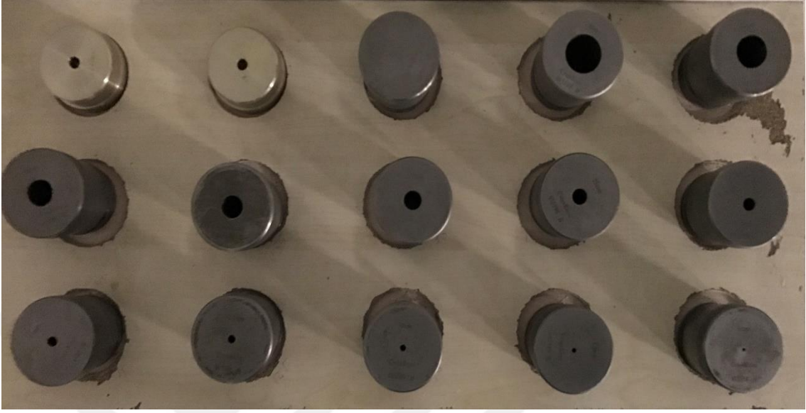
Şekil 2.2. Silindirik kolimatörler, çapları 5 - 60 mm aralığında değişmektedir.
