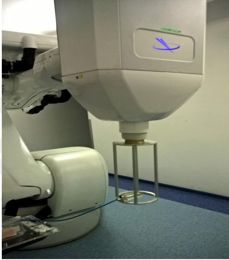
Şekil 3.18. Günlük doz ölçümü düzeneği.
