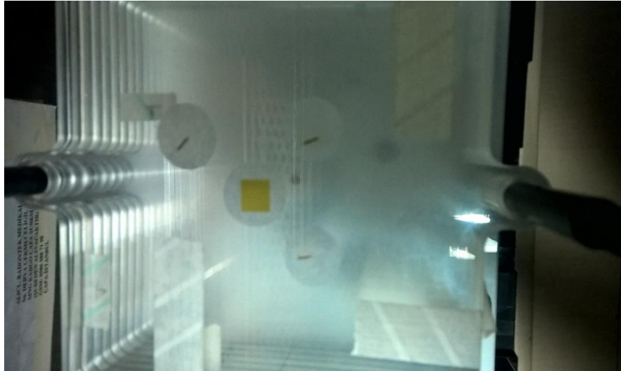
Şekil 3.5. Fantom plan merkezi ve yerleştirilmiş fidüsiyeler.
