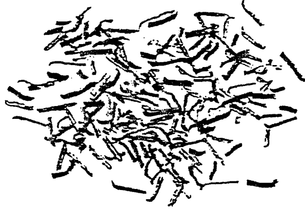
Şekil 2.2.6.1. Kırılmış Kısa Talaş Örnekleri
