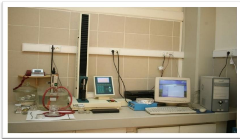
Şekil 3.1 : Hounsfield H5K-S Model mekanik test cihazı.
