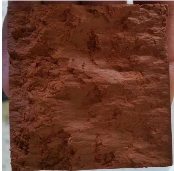
Şekil 4.29 : YS1 TKK deney sonrası kesme yüzeyi (S<%100)
