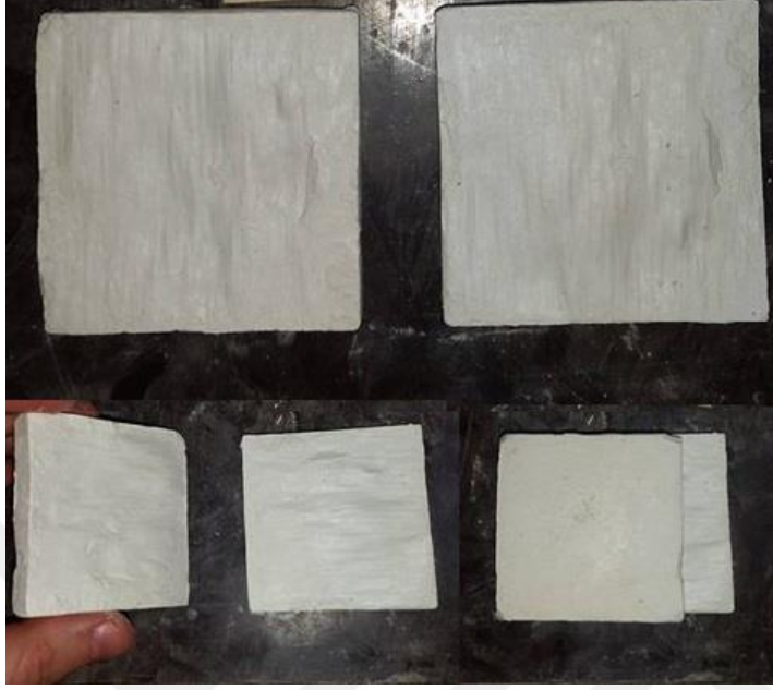
Şekil 3.15 : Tekrarlı kesme deneyi sonrası numune ve kesme yüzeyi (S=%100)
