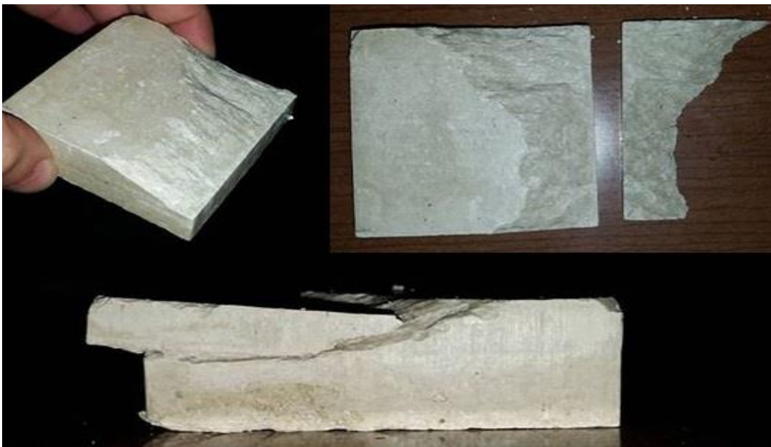
Şekil 4.31 : YS2 TKK deney sonrası kesme yüzeyi ( S < \%100 )
