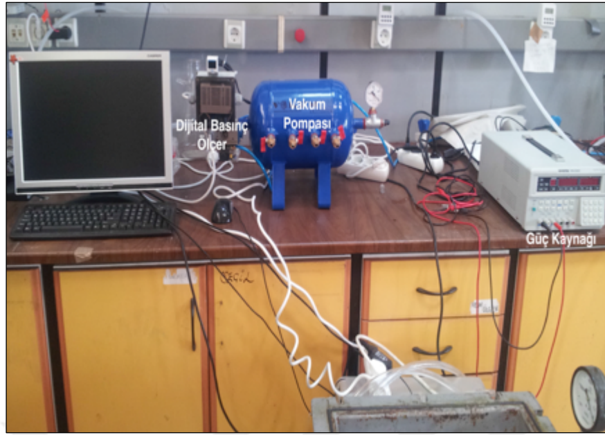
Şekil 3.3: BMEBR sisteminin vakum pompası ve güç kaynağı parçaları.
