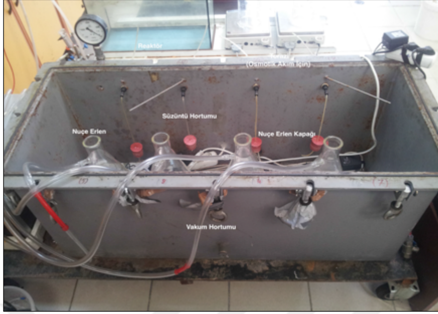
Şekil 3.5: Membran modüllerinden vakum altında toplanan süzüntünün biriktirildiği nuçeler.
