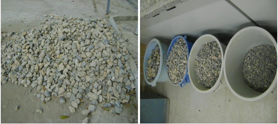
Şekil 4.3 Farklı tane boyutlarında elde edilen geri kazanılmış agregalar
