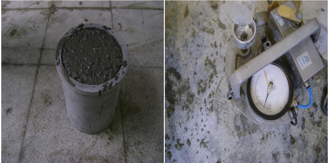
Şekil 4.8 Taze betonda hava içeriği tayini
