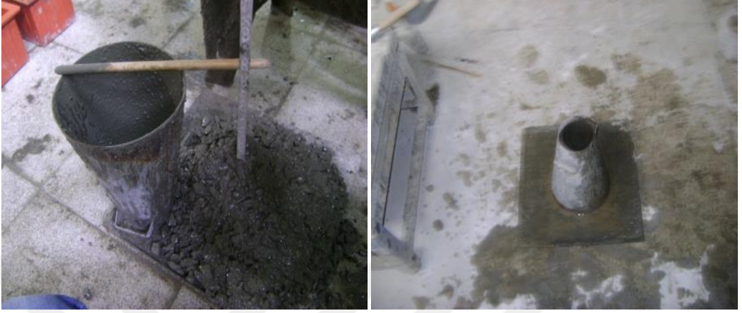
Şekil 4.7 Taze betonda çökme deneyi
