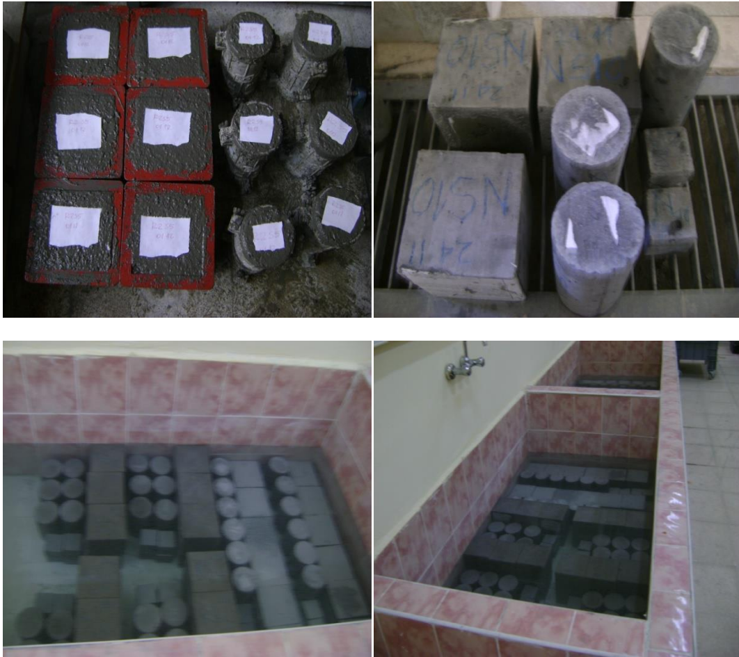
Şekil 4.4 Kalıplardan çıkarılan numunelerin kür edilmesi
