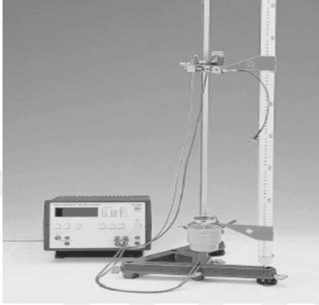
Sekil 1. Serbest düşme için deneyin kurulumu
