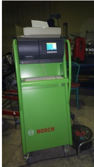
Şekil 3.9. Bosch BEA 350 model emisyon cihazı
