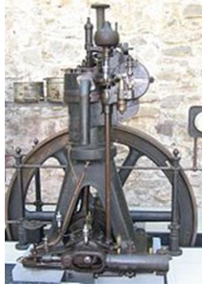
Şekil 1.1. Tek silindirli sabit dizel motoru, 1906 yapımı (Anonim 2015 a)
