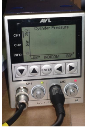
Şekil 3.8. Silindir içi basınç ölçer
