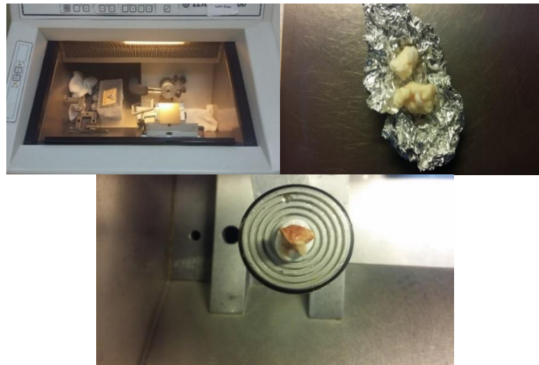
Şekil 3.5 Leica CM1900 Kyrostat cihazı ile 30\ \mu\text{m} 'lik kesit alımı
