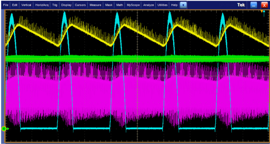
Şekil 4.43 : Yarım köprü dc/dc dönüştürücü dalga şekilleri sarı: doğrultulmuş gerilim mavi: doğrultulmuş şebeke akımı yeşil: çıkış akım mor: çıkış gerilim
