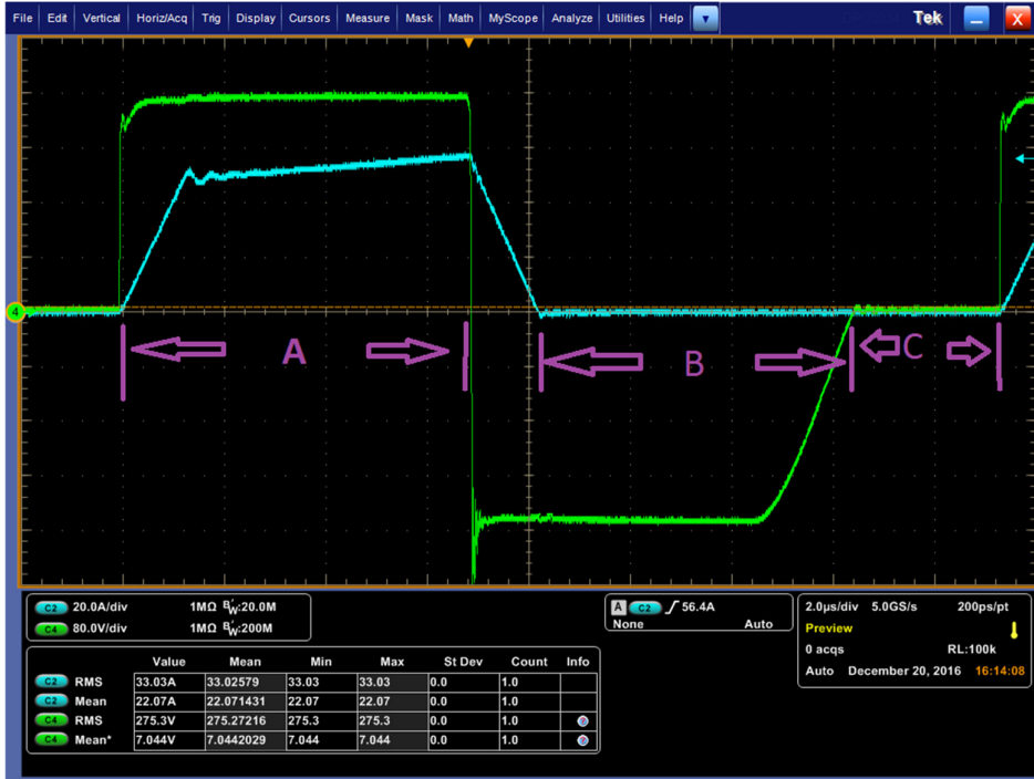
Şekil 4.7 : İleri yönlü dc/dc dönüştürücü primer akımı sarı: primer gerilimi mavi: primer akımı.
