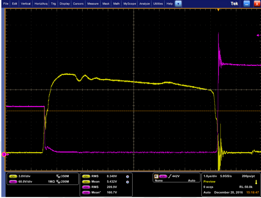
Şekil 4.6 : İleri yönlü dc/dc dönüştürücü T_1 anahtarı görüntüleri sarı: gate sinyali mor: kollektör-emiter gerilimi (yakınlaştırılmış).
