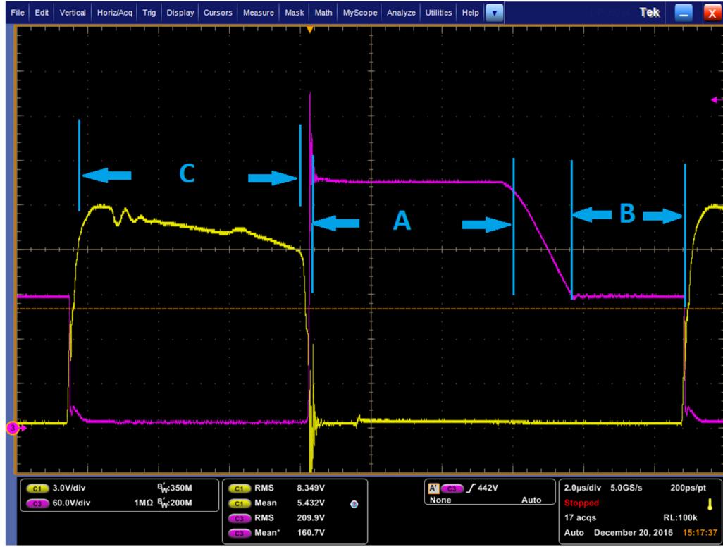
Şekil 4.3 : İleri yönlü DC/DC dönüştürücü T_1 anahtarı görüntüleri sarı: kapı sinyali mor: kollektör-emiter gerilimi
