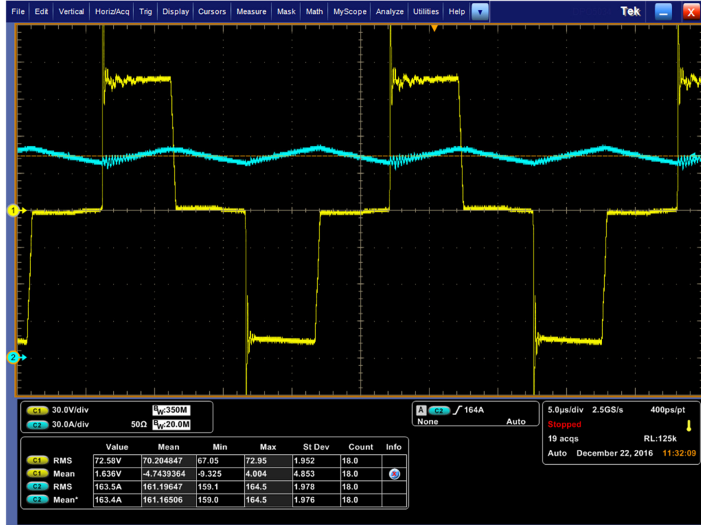
Şekil 4.18 : Üç seviyeli NPC DC/DC dönüştürücü sekonder dalga şekilleri mor: sekonder gerilimi yeşil: sekonder akımı.
