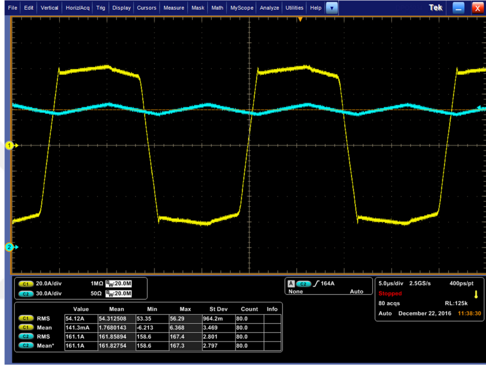
Şekil 4.20 : Üç seviyeli NPC DC/DC dönüştürücü primer ve çıkış akımları mavi: primer akımı yeşil: sekonder akımı.
