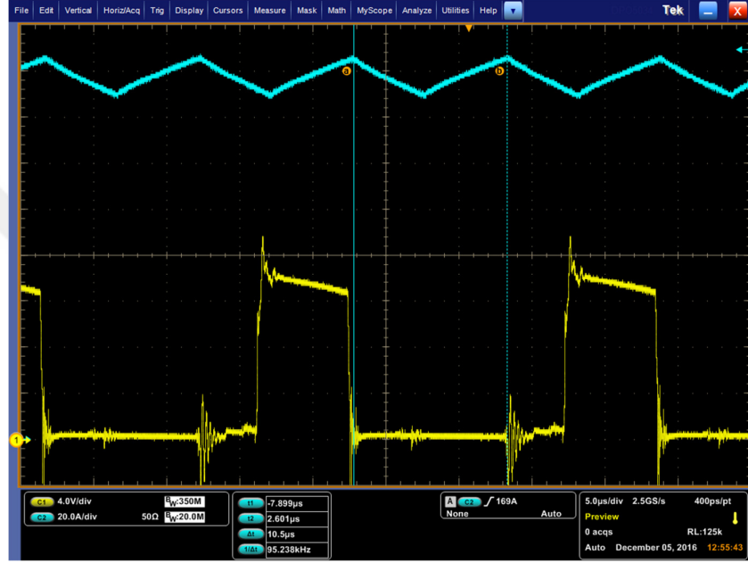
Şekil 4.36 : Faz kaydırmalı tam köprü DC/DC dönüştürücü sekonder akımı sarı: T_4 sürme sinyali mavi: çıkış akımı
