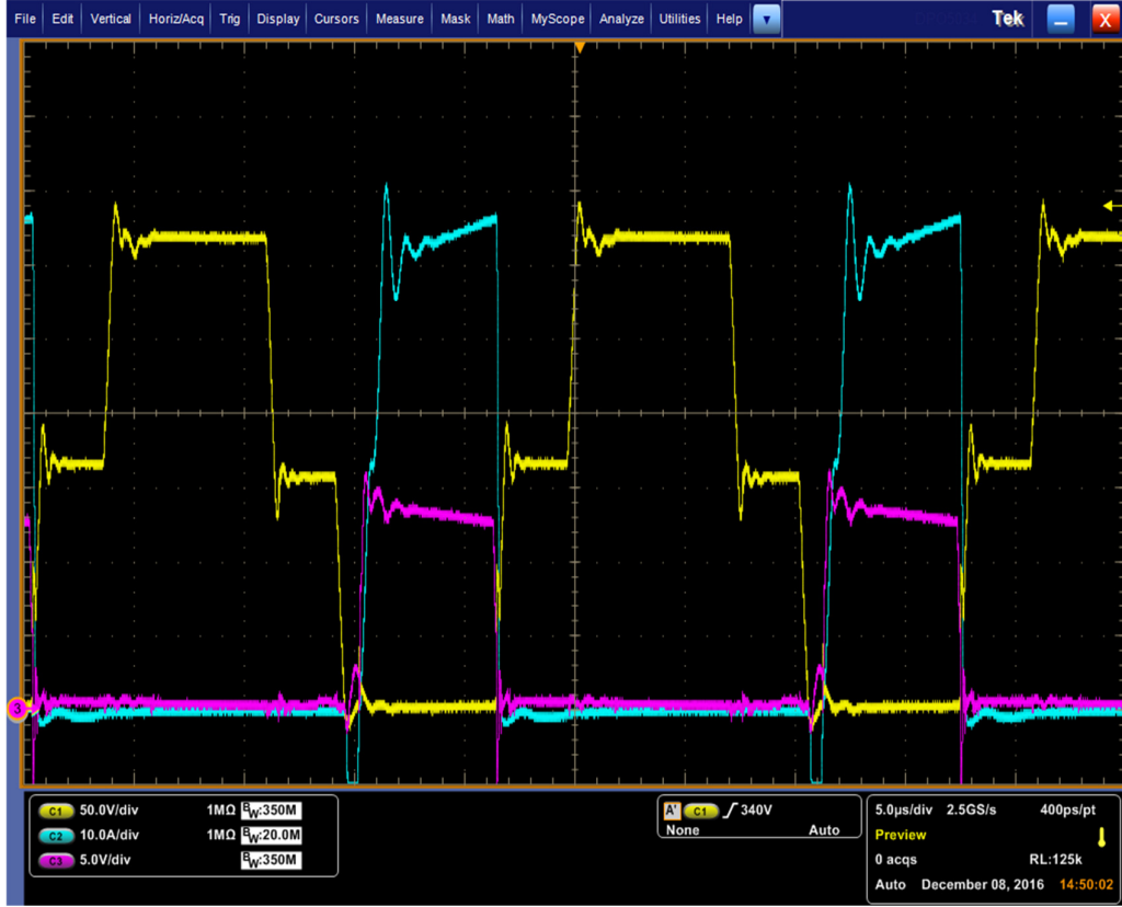
Şekil 4.22 : Üç seviyeli NPC DC/DC dönüştürücü T_1 anahtarı sinyalleri sarı: gate sinyali mavi: anahtar akımı mor: kollektör-emiter gerilimi.
