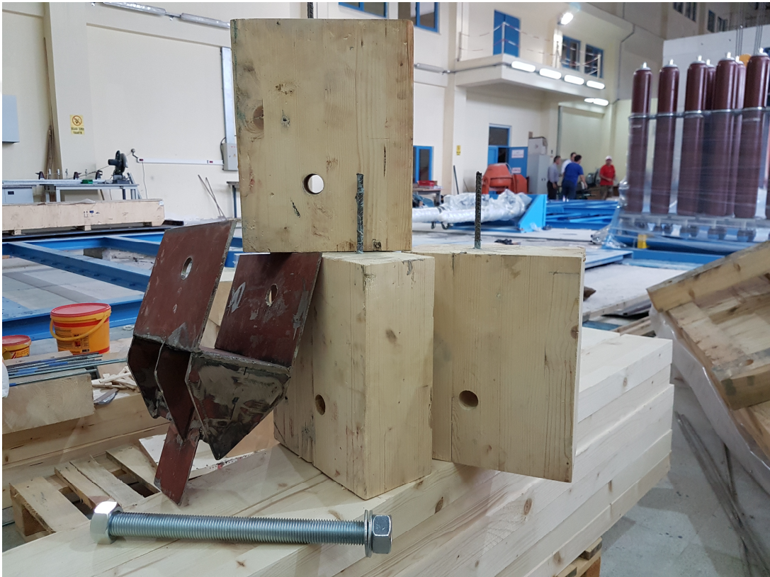
Şekil 3.8 Pull - out fikstürü ve numuneleri
