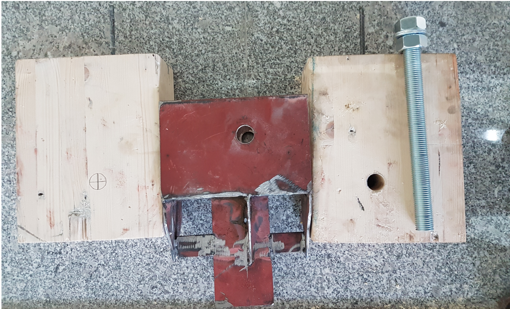
Şekil 3.7 Numunelerin pull - out fikstürüne oryantasyonu
