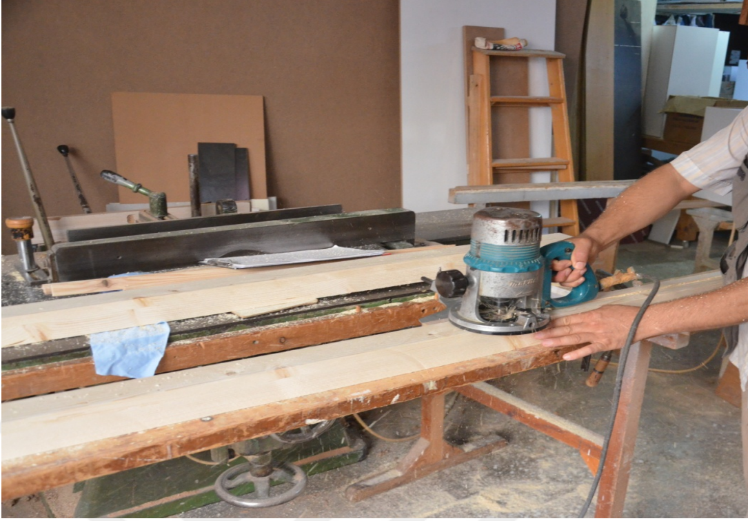
Şekil 3.11 MID kodlu numuneye kanal açılması işlemi
