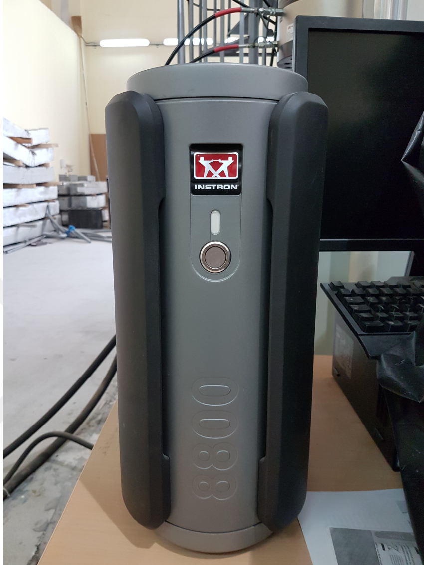
Şekil 3.2 Instron 8800 kontrol istasyonu
