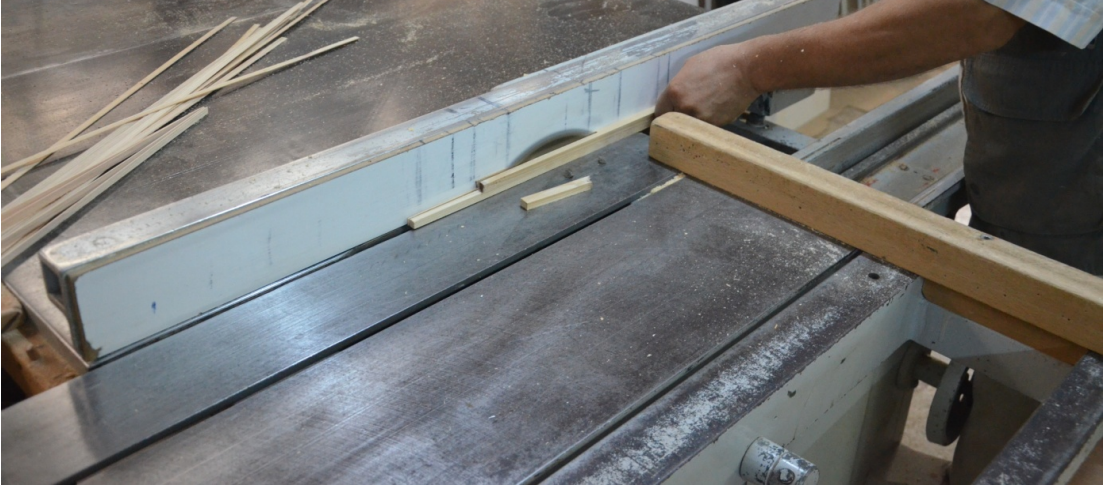
Şekil 3.15 Laminasyon işlemi için çita üretimi
