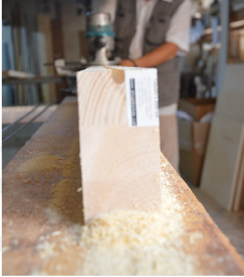
Şekil 3.14 BOT kodlu numuneye kanal açılması
