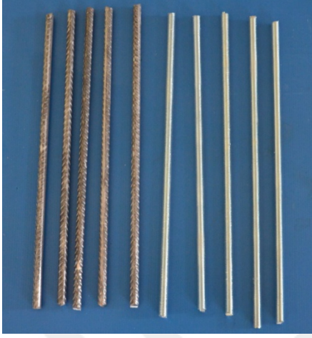
řekil 3.19 elik ekme numuneleri
