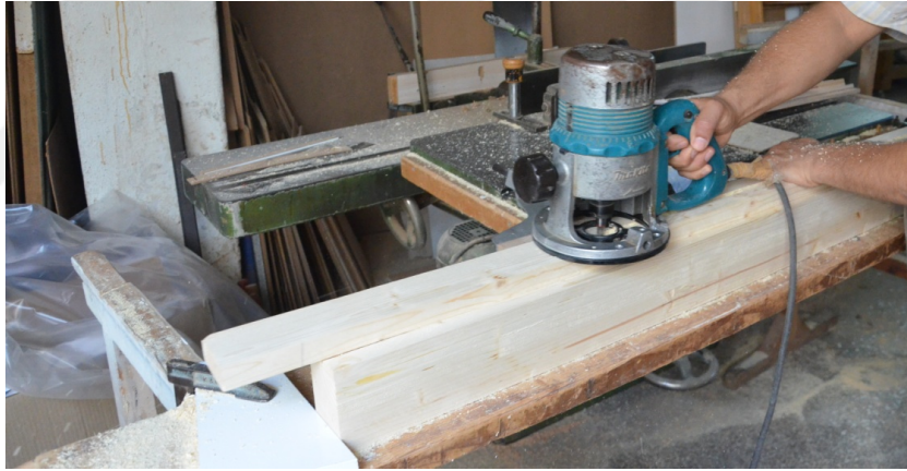
Şekil 3.13 LOW kodlu numuneye kanal açılması
