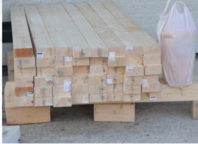
řekil 3.21 Drt noktalı eęilme deneyi numuneleri
