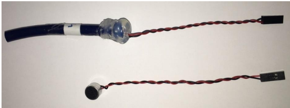
Şekil 3.14 : Mikrofonlarda Gürültünün Engellenmesi Çalışmaları.
