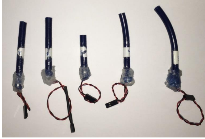
Şekil 3.12 : Çalışmada Kullanılan Beş Farklı Elektret Mikrofon.
