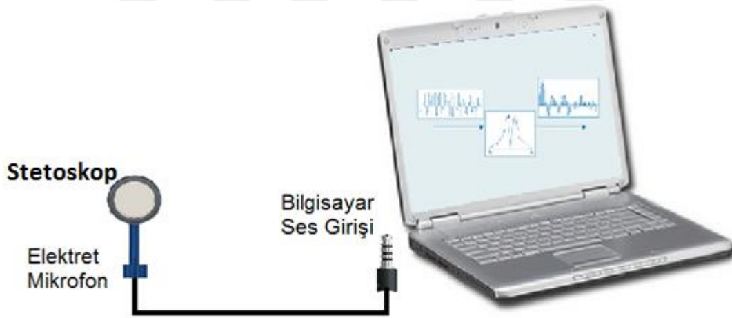
Şekil 3.16 : Mikrofon ile Bilgisayar Arasındaki Bağlantı Yapısı.
