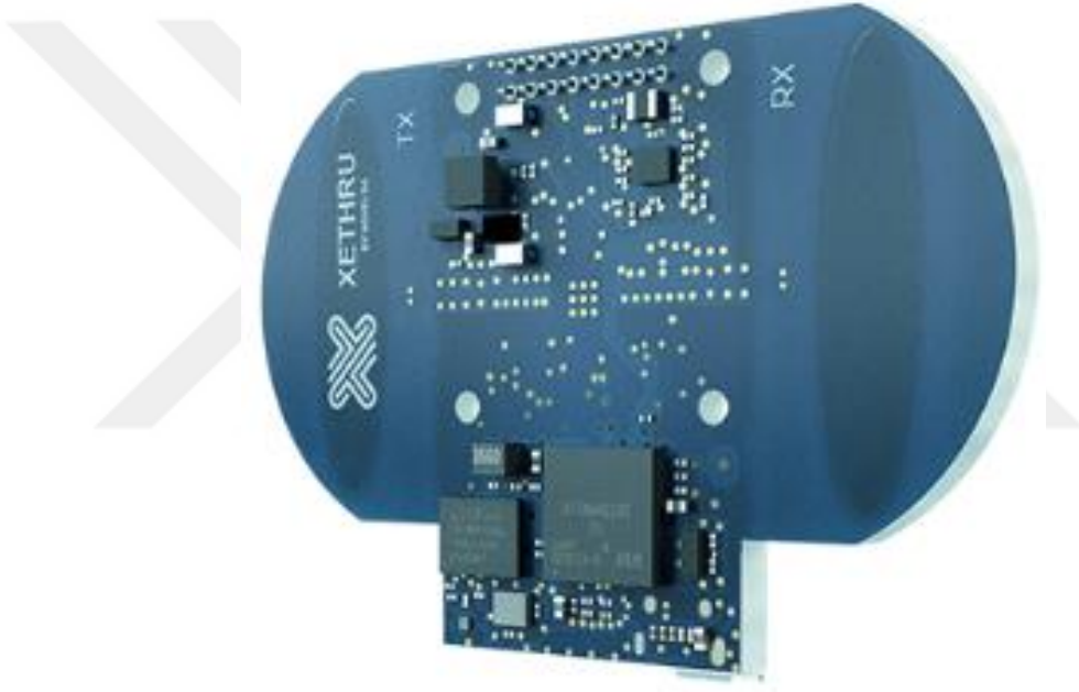
Şekil 3.10 : Örnek Bir Non-Contact Sensör[23].
