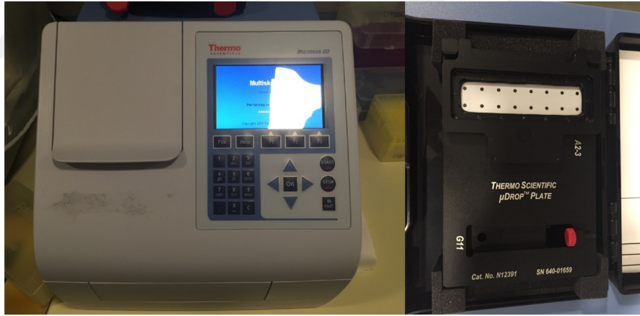
Şekil 3. 17. Mikrodrop spektrofotometre cihazı (Thermo Scientific, MultiScan GO)
