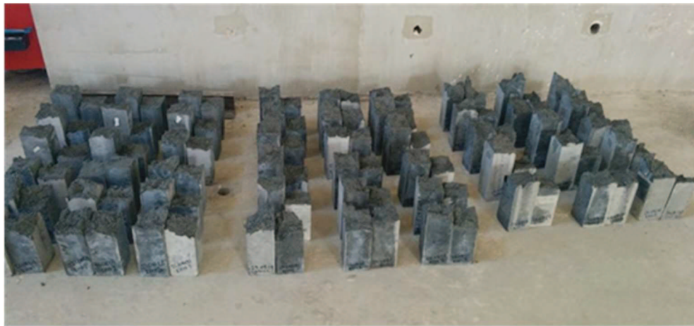
Şekil 2.9: Testleri tamamlanan prizma numuneler
