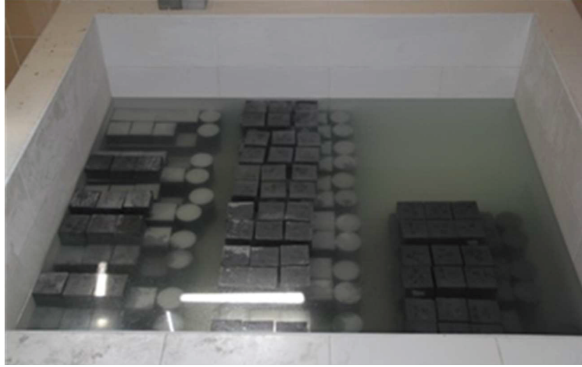
Şekil 2.5: Kür havuzundaki test numuneleri
