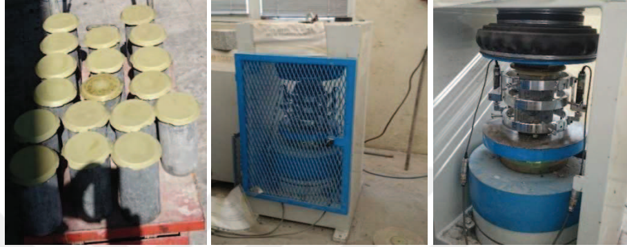
Şekil 2.7: Elastisite modülünün tayini için başlıklanan numuneler, basınç presi ve ölçüm düzeneği
