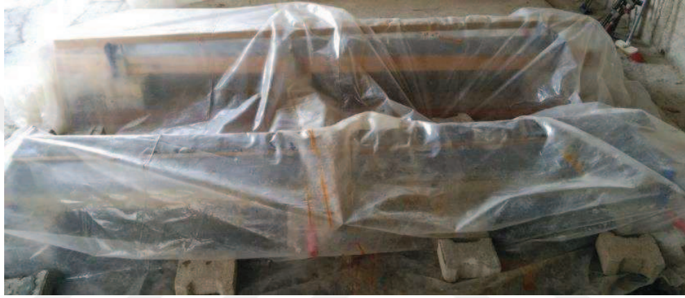
Şekil 2.21: Plastik örtü ile sarılmış test kirişleri
