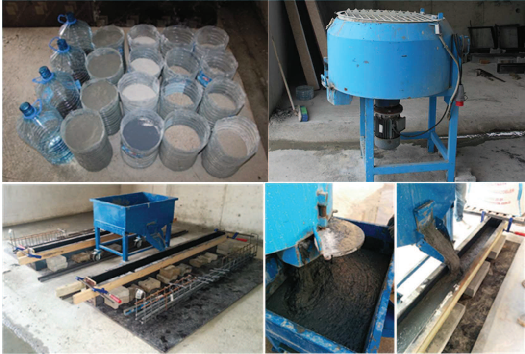
Şekil 2.19: UYPLB’un hazırlanması ve kiriş kalıplarına yerleştirilmesi
