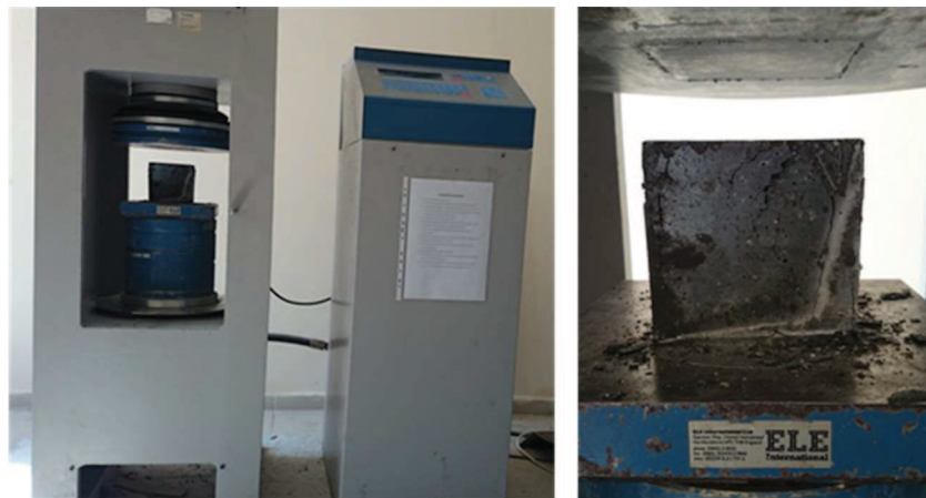
Şekil 2.6: Numunelerin beton basınç dayanımlarının belirlenmesi
