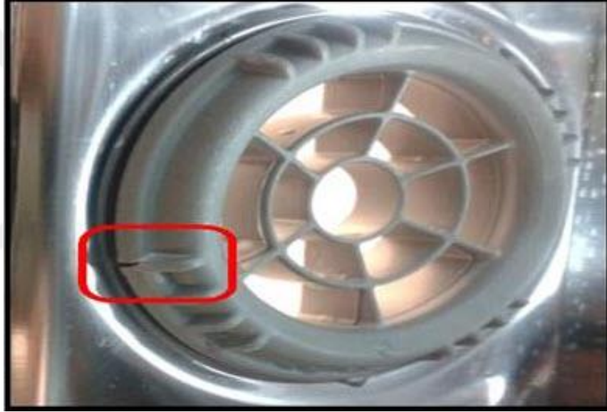
Şekil 3.10 Çatlak oluşumunun gözlemlendiği bölge
