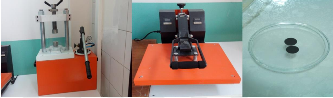
Şekil 3.1. Disk-pelet elektrotların hazırlanması.
