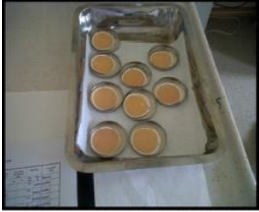
Şekil 3.7. Planşetlere yerleştirilen filtrelerin, ölçme işlemi için sayım sistemine alınması
