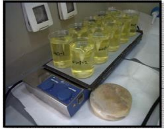
Şekil 3.4. Isıtıcı/manyetik karıştırıcı üzerinde bulunan beherlerdeki su örnekleri. Sülfirik asit, bromocresol purple indikatör çözeltisi ilave edilmiş su örnekleri
