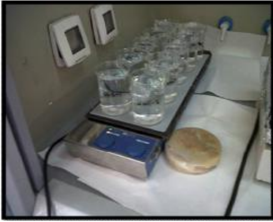
Şekil 3.4. Isıtıcı/manyetik karıştırıcı üzerinde bulunan beherlerdeki su örnekleri. Sülfirik asit, bromocresol purple indikatör çözeltisi ilave edilmiş su örnekleri
