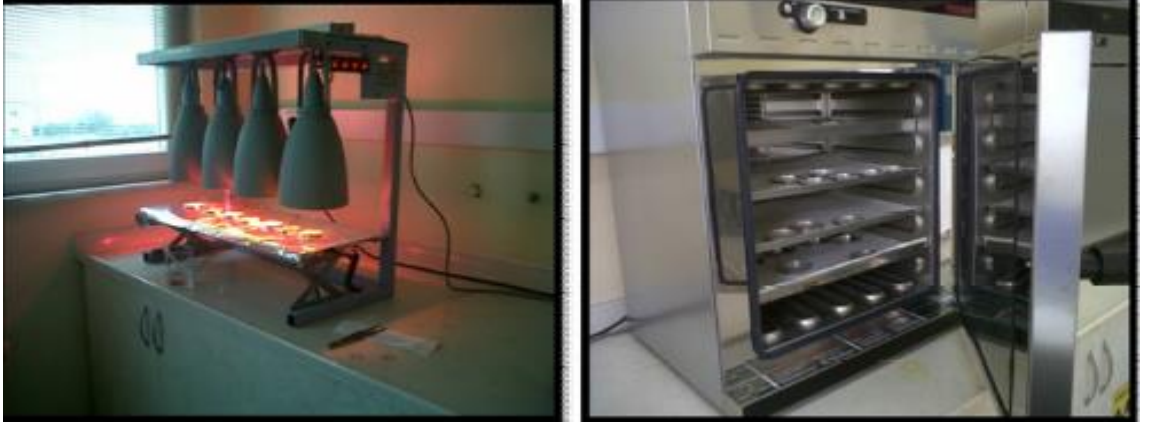
Şekil 3.8. Kızıl ötesi lamba altında buharlaştırma işlemi ve etüvde kurutulan su örnekleri
