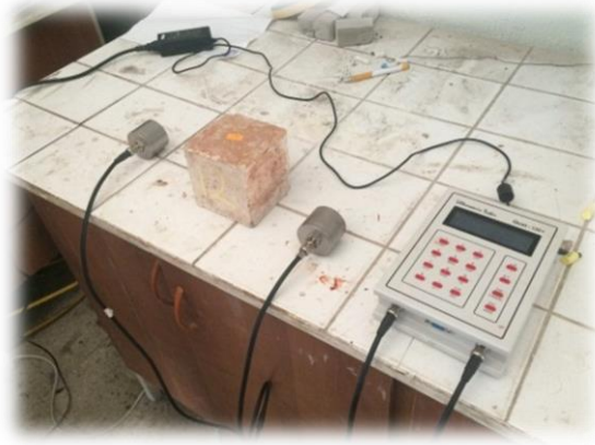
Resim 3.12 Ultra ses deneyi.
