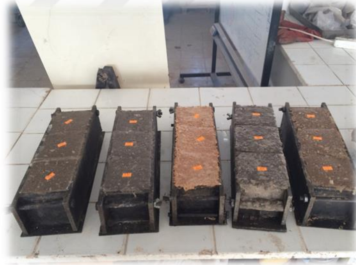
Resim 3.10 Etüvden çıkan geopolimer betonlar.
