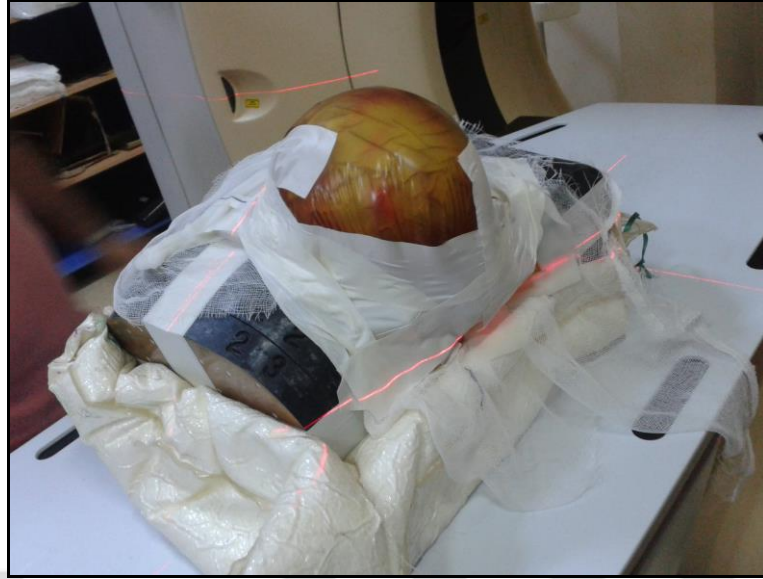
Şekil 3-18 Meme Expanderinin 1 cm bolus malzemesi ile BT çekimi
