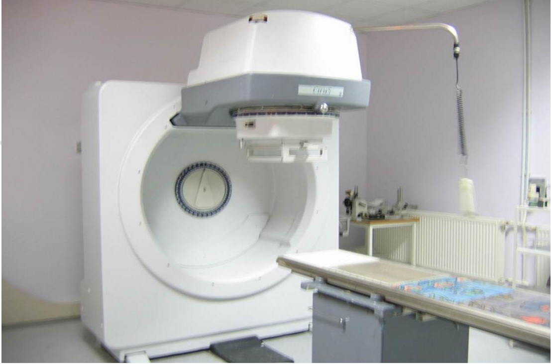
Şekil 3-2 Co 60 Teleterapi Cihazı
