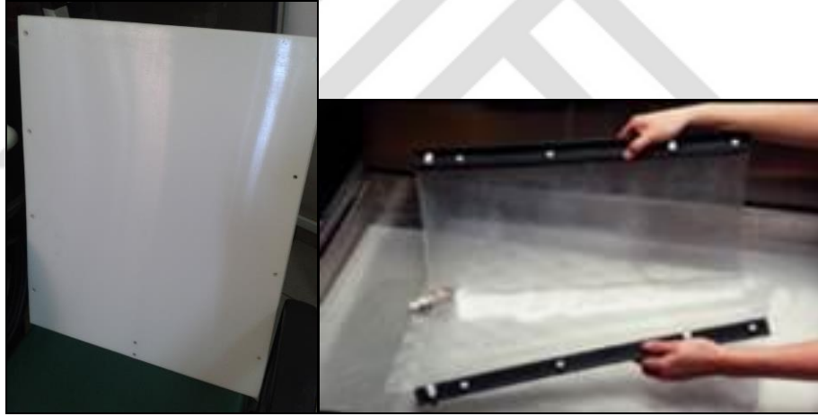
Şekil 3-15 Termoplastik plakanın hazırlanma aşaması
