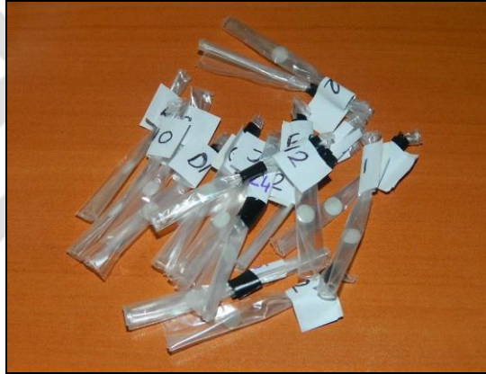
Şekil 3-22 Işınlanmaya hazırlanan TLD'ler
