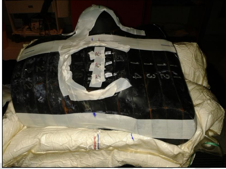
Şekil 3-23 Expanderin altına yerleştirilen 3 TLD noktası
