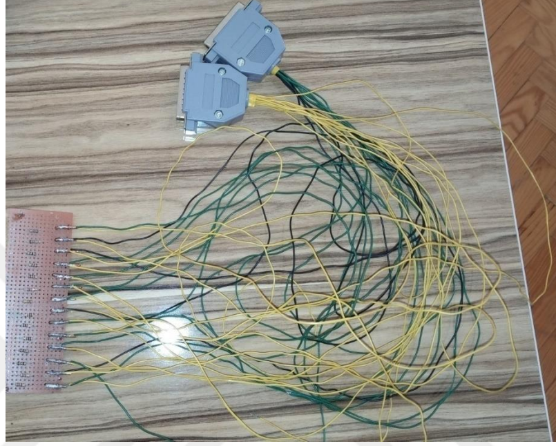
Şekil 3.5. Veri okuma kartı ile bağlantılı çalışan direnç köprüsü.
