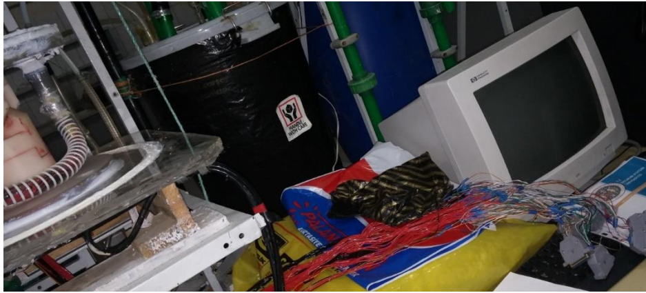
Şekil 3.4. Veri okuma kartı ile bağlantı sağlayan kablo hattı ve soketler
