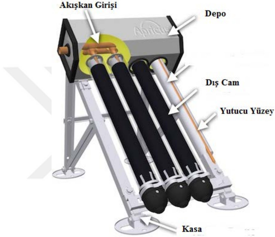
Şekil 4.1 Boşaltılmış Tüplü Kolektör Sisteminin Parçaları
