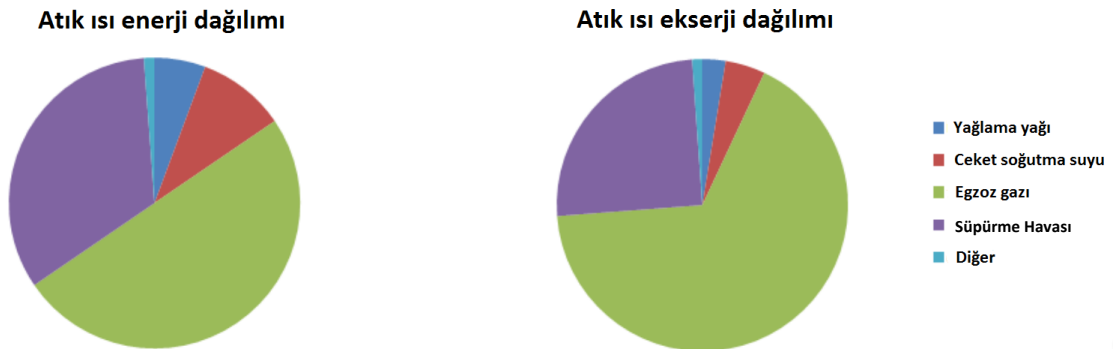
Şekil 2.5 : Bir gemi dizel motorunda enerji ve ekserji dağılımı (Bellolio ve diğ., t.y.).
