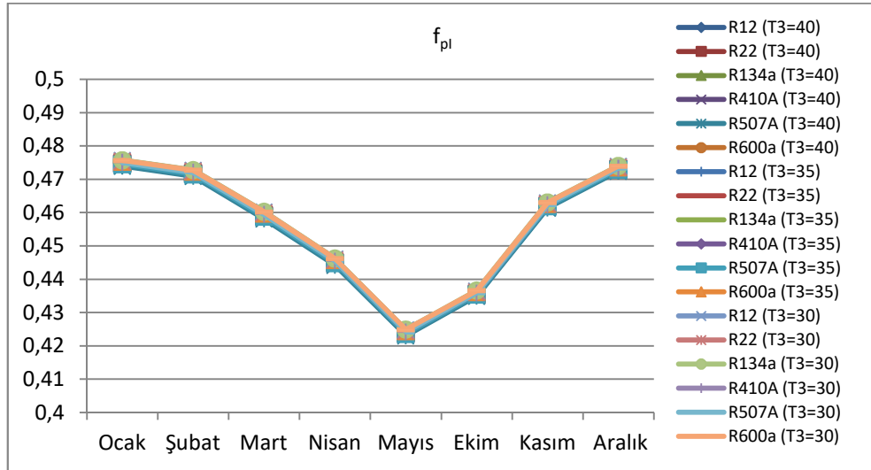
Şekil 6.29. Toprak kaynaklı ısı pompasında I. sirkülasyon pompasının eksergo-ekonomik faktörü.
