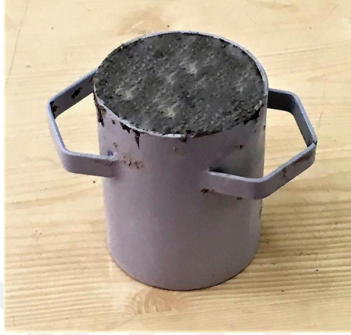
Şekil 3.5. Birim ağırlık deneyi
