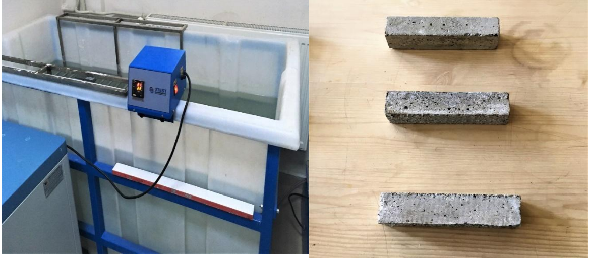
Şekil 3.7. Su emme deneyi
