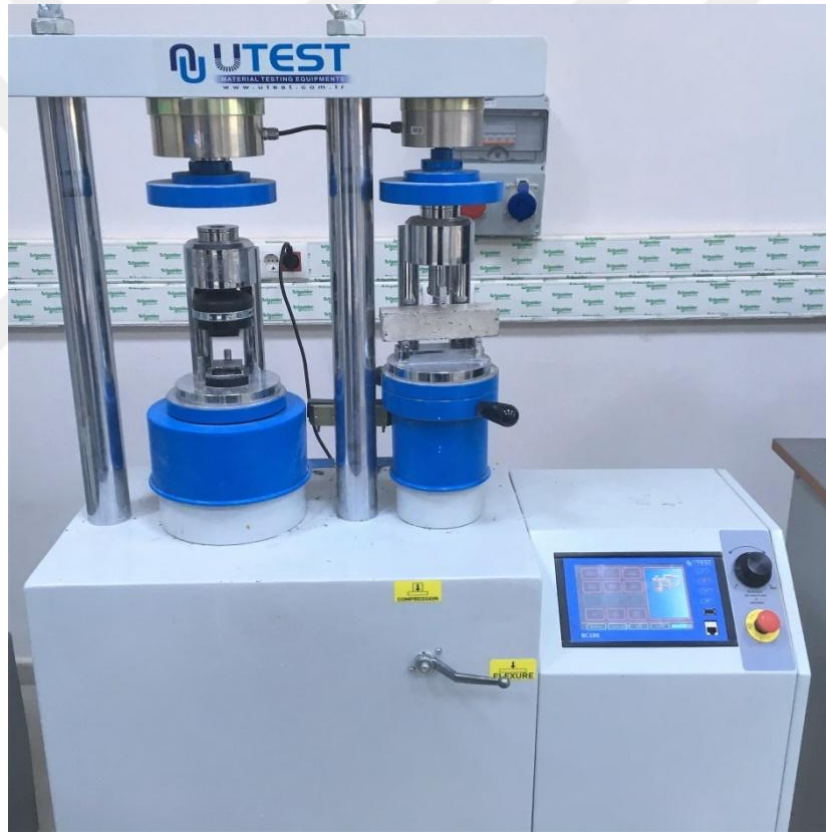
Şekil 3.9. Eğilme ve basma dayanımı deneyi
