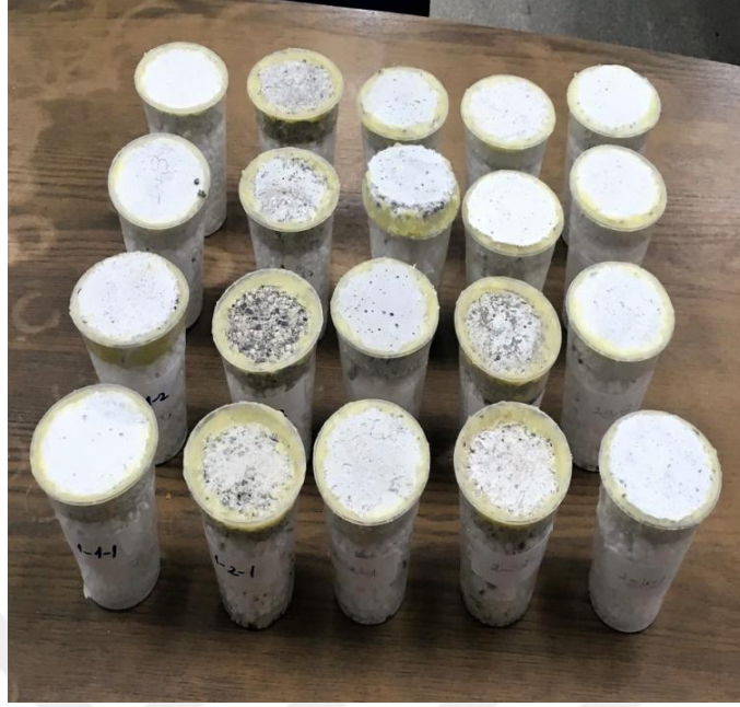
Şekil 3.8. Buhar geçirgenlik deneyi
