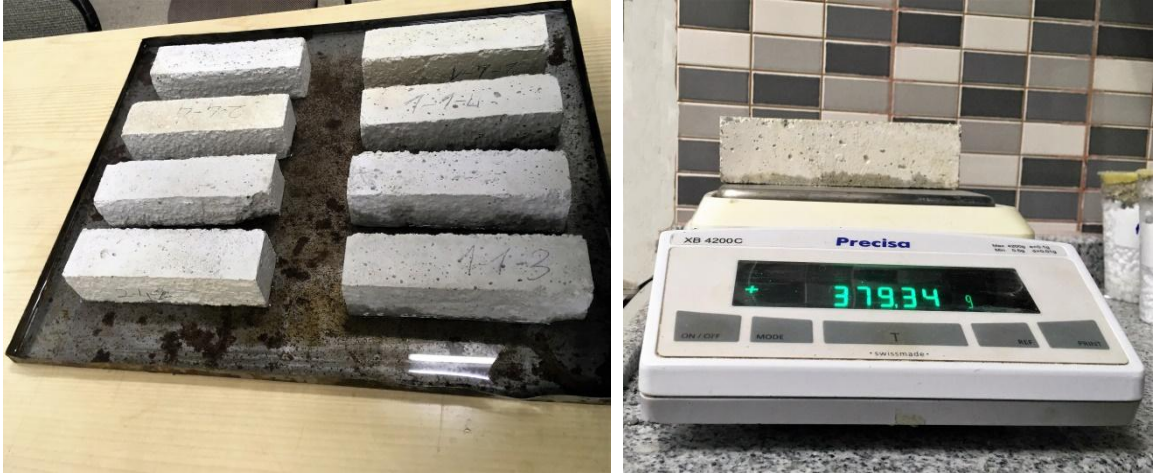
Şekil 3.6. Kılcal su emme deneyi
