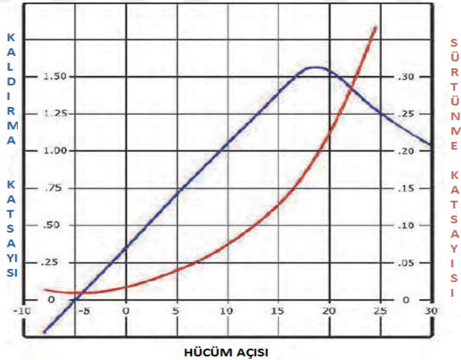
Şekil 3. 10 Kanat kesiti üzerindeki sürüklenme ve kaldırma kuvveti
