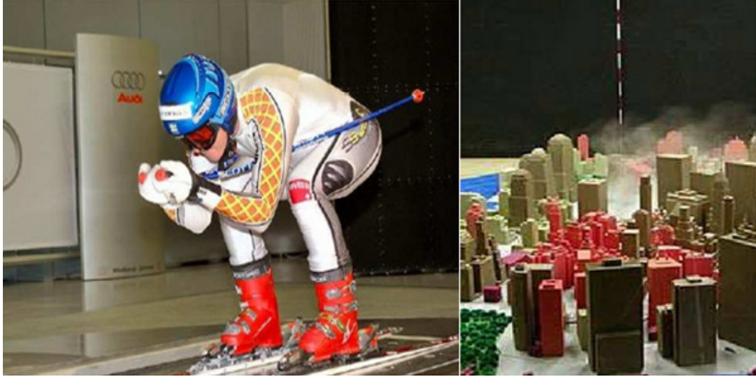
Şekil 2. 1 Rüzgar tüneli kayakçı sürtünme katsayısı ve şehir hava kirliliği yayılması
