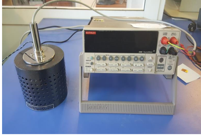
Şekil 3.19. Dört nokta (Four Probe) akım-gerilim ölçüm sistemi
