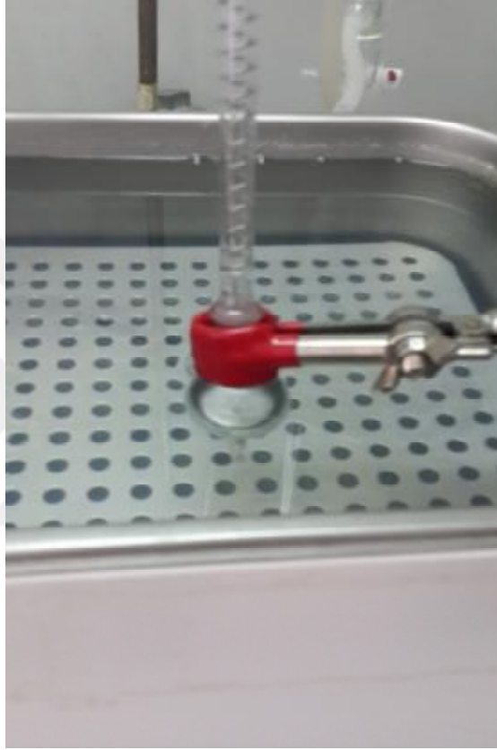
Şekil 3.5. Vigreux kolon ile konsantrasyon işlemi
