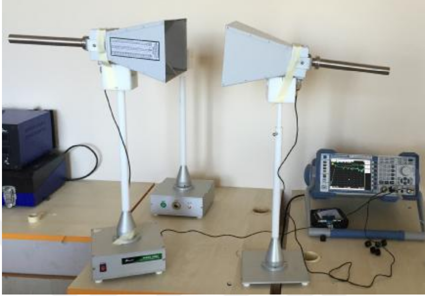
Şekil 3.11. Ekranlama etkinliği ölçümde kullanılan düzenek
