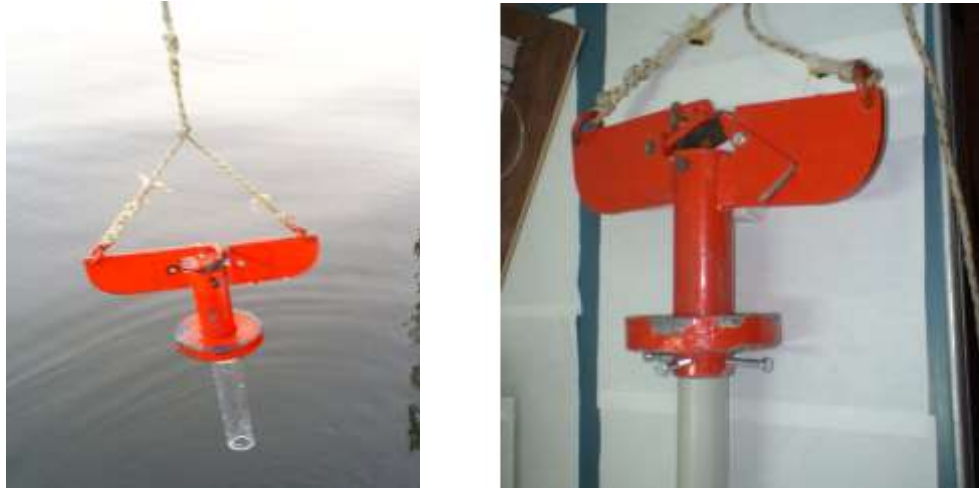
Şekil 3.2 5cm yarıçaplı (ID) Yerçekimsel Karot Örnekleyici (Gravity Corer) (Özkan 2008'den alınmıştır.).
