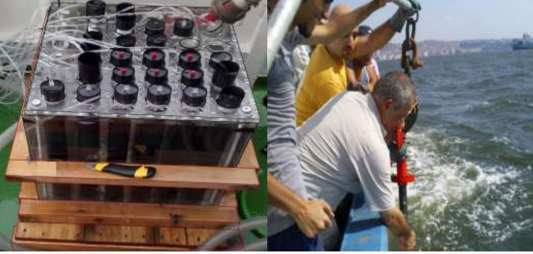
Şekil 3.4 Sediment örnekleme ve tekne üstünde core inkübasyonu
