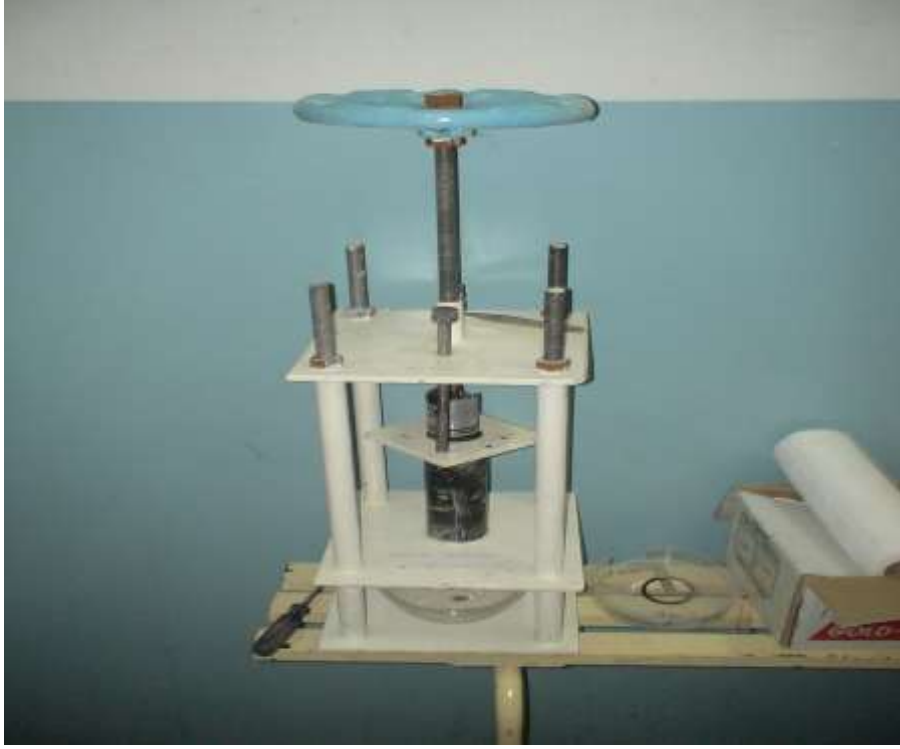
Şekil 3.3 Fakültemizde Geliştirilen Pore Water Squeezer (Sediment Ara Suyu Çıkarıcı).
