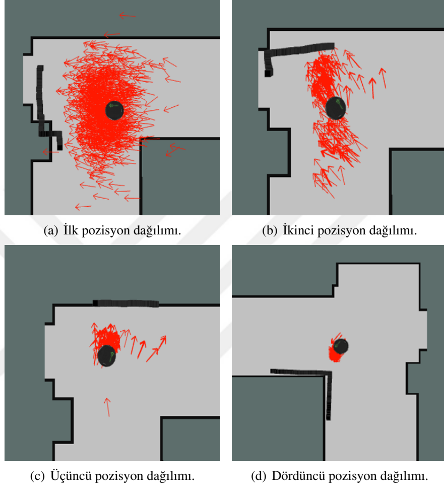
Şekil 3.3 : AMCL konumlandırma aşamaları, robotun olası konumları(kırmızı oklar), sensör ölçümleri (siyah kareler) ile gösterilmiştir.
