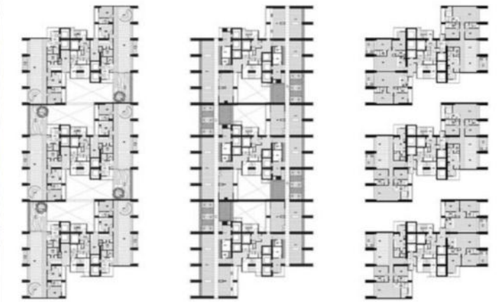
Çapraz havalandırmaya imkan veren dört tarafı açık planlama [258]
