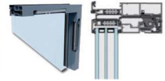
Paralel pencere doğrama içine motor yerleşimi ve kesit(üstte) [277]
